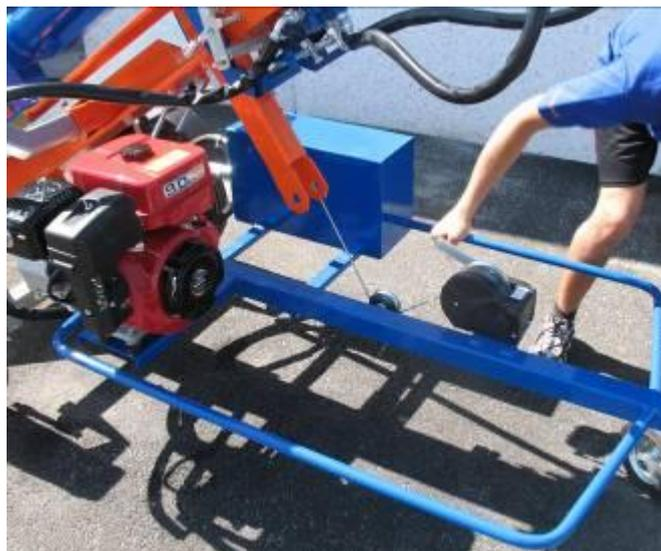
Quando viene sganciato il carrello dal mezzo semovente si consiglia di sollevare lo spaccalegna (in posizione verticale) o di sistemare dei cunei di blocco sulle ruote, in modo da garantire la stabilità del carrello.
