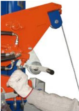
Raggiunto il ceppo da prelevare agganciarlo con la pinza (E), portarsi presso lo spaccalegna, sganciare il cavo in acciaio dalla puleggia (A) e agire sulla leva del distributore (B) per azionare l'argano fino a che il ceppo si posizionerà in posizione verticale al di sotto del cuneo di taglio.
